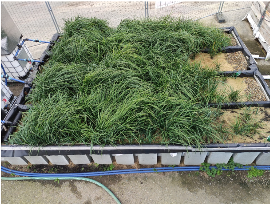
Abbildung 4: Foto der bepflanzen Bodenfilter
